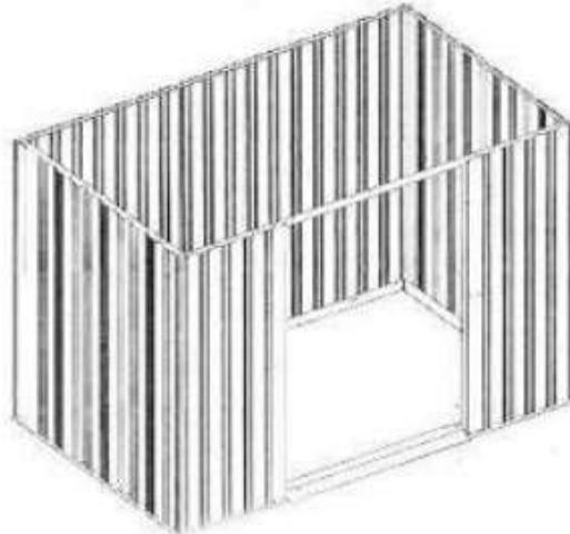
**6. Așezați 4 bucăți de panou frontal (21L) și (21R) deasupra glisierei şine (7;8) și pe partea din spate a barelor superioare (10L,10R), aliniindu-le găurile decupate și fixați-le împreună cu șuruburi F1 din interior. Apoi reglați cele 2 panouri de frontal**
