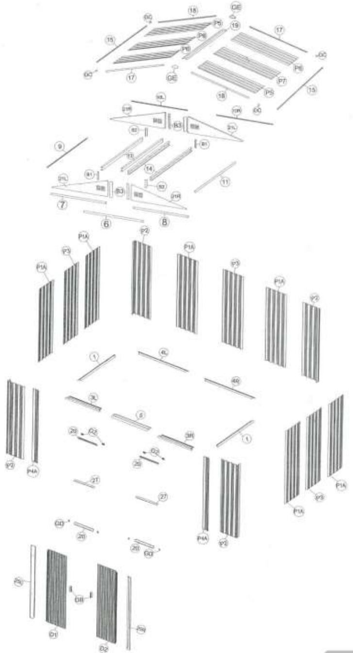
**1. Asamblați barele de bază de la (1) la (4L) cu ajutorul șuruburilor marcate F1. Apoi instalați intrarea (5) pe partea superioară a (3L) și (3R). Se fixează la bază cu șuruburile marcate F1, aşa cum se arată în imaginea de mai jos aşa cum se arată mai**
